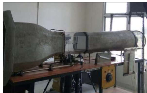
Gambar 3. Instalasi pengujian pada wind tunnel sub-sonic
